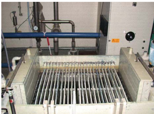
Mehrkathodenzelle zur kathodischen Reduktion von Azofarbstoffen
