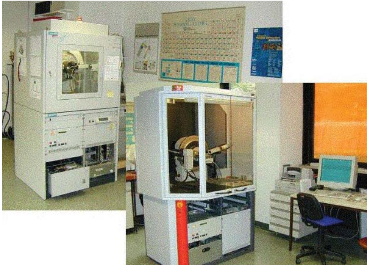
Beispiele für die Röntgenbeugungsausrüstung zur Materialcharakterisierung (Pulverdiffraktometrie) am Institut (z.B. Hochtemperaturdiffraktometrie bis 1200°C)
