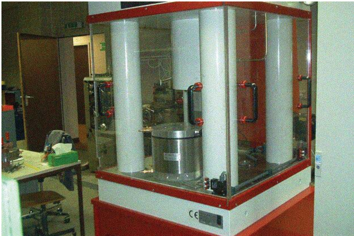
Multi-Anvil-Press für Experimente und Synthesen im Hochdruckbereich (> 100 kbar)
